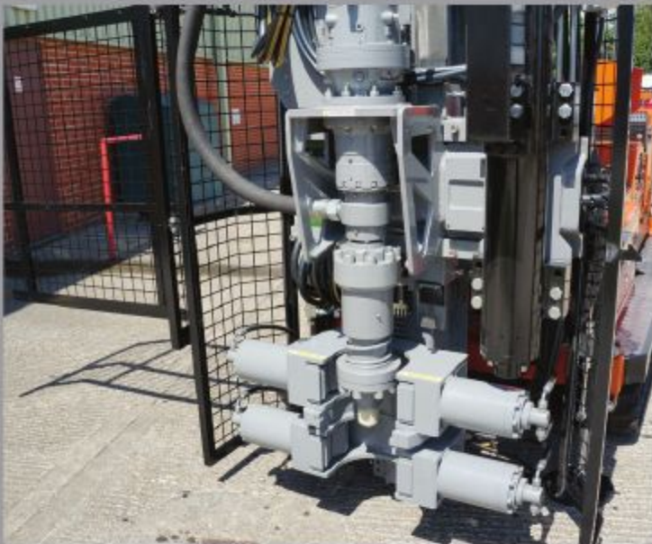
4 速动力头安装在带浮动主轴的液压侧滑装置上， 50mm-240mm 双钳夹持器
