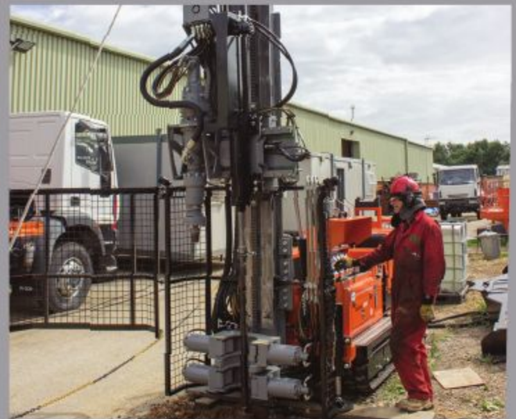
选配的丹顿 3D 系统旨在推进套管的过程中，原装采取 土样土壤样品。
